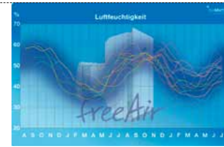
Die Messwerte über zwei Jahre an 43 Kundenprojekten von bluMartin zeigen, dass die relative Luftfeuchtigkeit stets im Behaglichkeitsbereich zwischen 30 % und 60 % liegt
